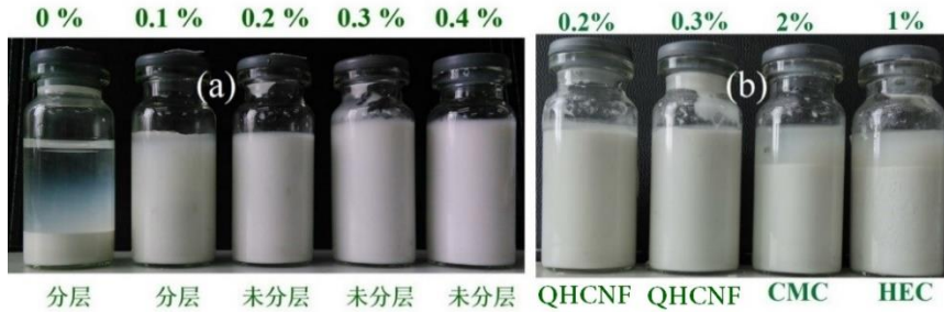
图 3 (a)用不同 CNF 加入量和(b)不同分散剂分散 600 目硅微粉的稳定性的测试结果(7 天后)
